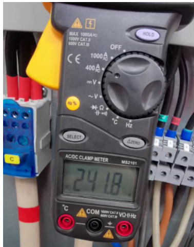
Рис. 1. Измерение пускового тока
